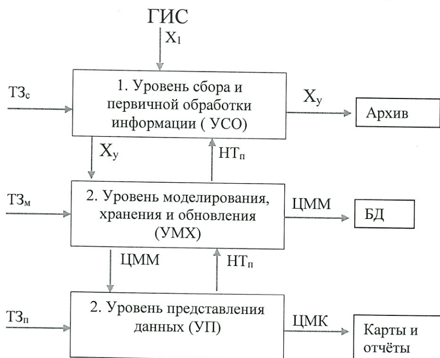
Рис. 1 Структура обобщённой ГИС
